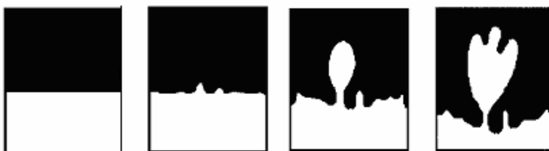
FIGURA 2.3 – Ilustração da Teoria da instabilidade hidrodinâmica RT, FONTE: Kelley (1989, pag. 76 e 122) retirada da dissertação Rodrigues, 2003.
